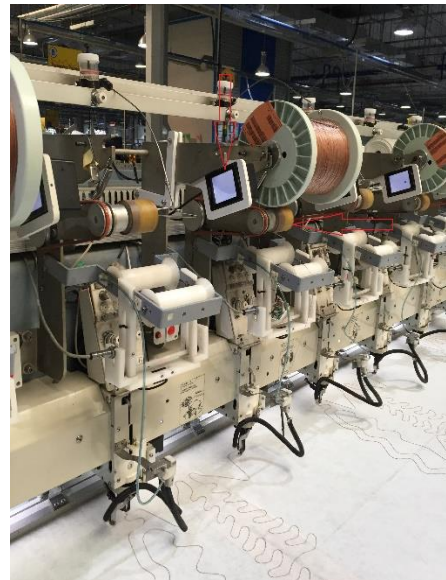
Слика 8.31. Автоматски систем за контрола на потрошувачката на жица
