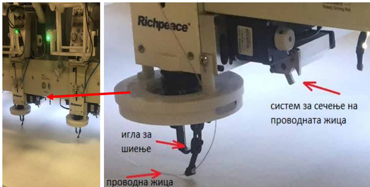
Слика 8.30. Систем за сечење на проводна жица на машината за шиене
