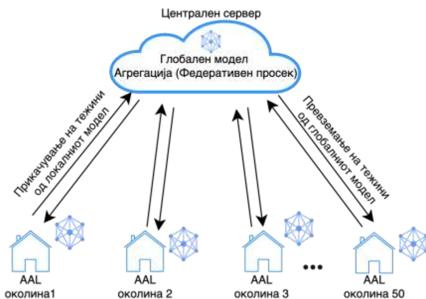
Слика 6.16. Архитектура на FL системот. Клиентите во ова сценарио претставуваат AAL (Ambient Assisted Living) средини или паметни домови. Секој клиент обучува локален модел, користејќи ја истата DNN која е искористена во експериментите за длабоко учење, со нивните соодветни локални податоци. Откако ќе се завршат однапред одреден број на локални епохи, FL клиентите ги пренесуваат само тежините на моделот до централниот сервер. Централниот сервер потоа ги собира овие модели и го ажурира глобалниот модел користејќи го FedAvg алгоритмот.
