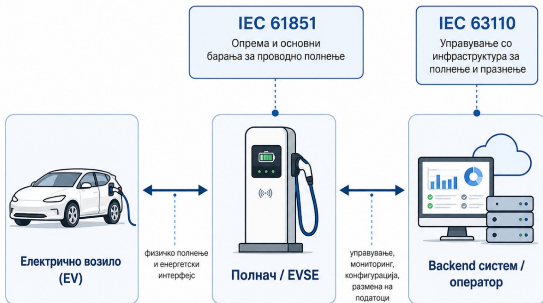
Слика 5.4: Улогата на IEC 61851 и IEC 63110 во инфраструктурата за полнење електрични возила
