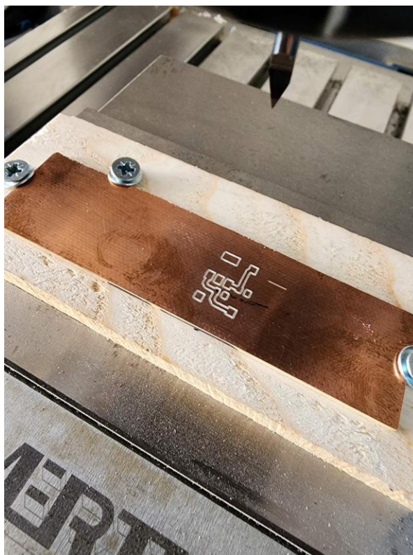
Слика 4.12. Машинска CNC-обработка на прототип на мала електронска плочка со димензии 13 \times 16 mm со користење на прецизен алат за гравирање.
