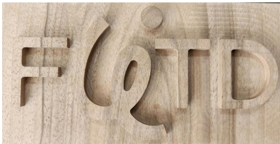
Слика 4.11. Машинска CNC-обработка во висококвалитетно суво дрво од орев со користење на троперно глодало со дијаметар од 4 mm.
