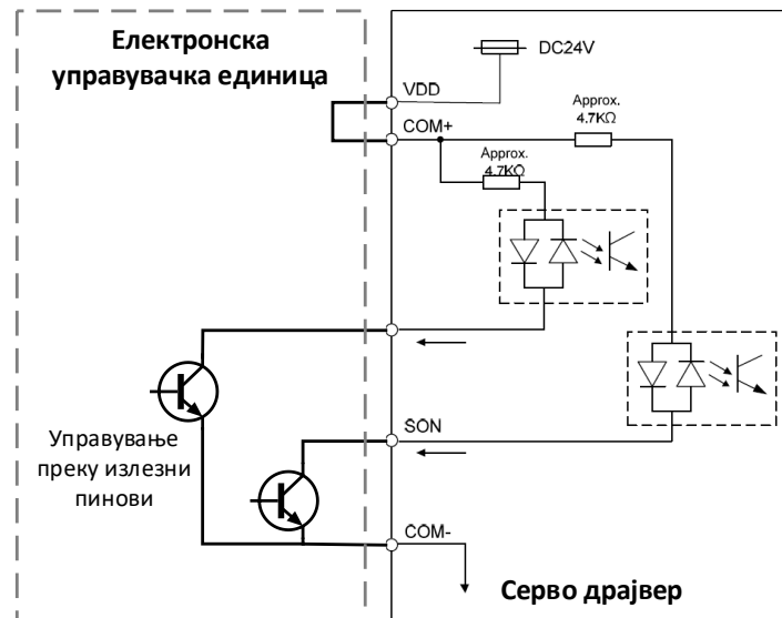
Слика 2.5. Поврзување на податочните дигитални излези од ЕУЕ со влезовите на серводрајверот.
