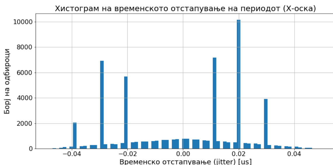
Слика 4.8. Хистограм на измерените временски отстапувања на периодот за X-оската. Сите измерени вредности се наоѓаат во границите од \pm 0.05 \mu\text{s} , што одговара на интервалот на семплирање на осцилоскопот.
