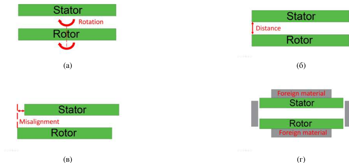
Слика 8.1: Различни примери за тестирање кои може да бидат предмет на интерес при испитување на карактеристиките на еден сензор за мерење на аголна позиција. Сензорот може да се тестира: при ротација на роторот (а), при различни растојанија помеѓу статорот и роторот (б), при заемно хоризонтално поместување помеѓу статорот и роторот (в), при присуство на страни тела (г).
