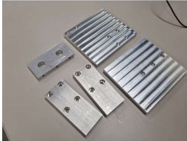
Слика 8.18: Дополнителни алуминиумски делови изработени за намените на роботската рака.
