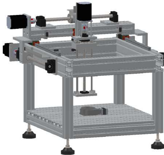
Слика 8.6: 3Д модел на целокупна изведба на Декартова роботска рака со четири степени на слобода од кои три степен на слобода се реализирани со призматични зглобови, а четвртиот степен е реализиран со ротирачки зглоб.
