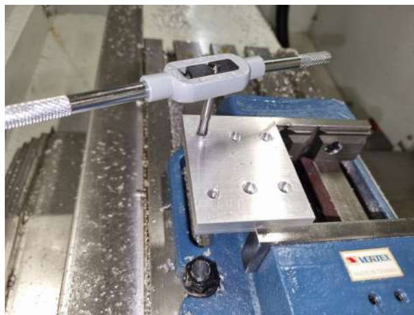
Слика 8.19: Илустрација на пример за режење на навој кај дупки со помош на рачна нарезница.
