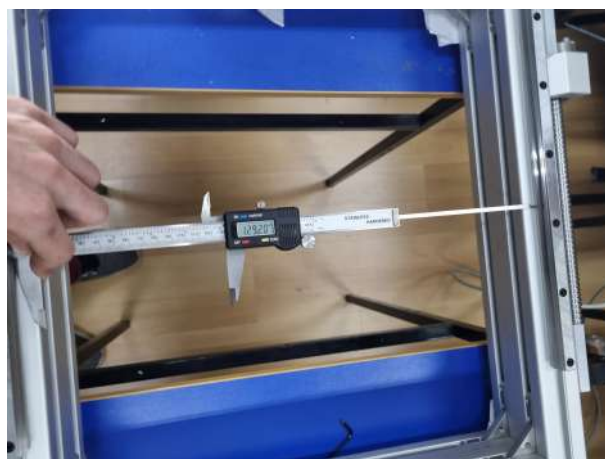
Слика 8.22: Проверка на паралелност помеѓу линеарните водилки на дуалната Y оска од роботската рака.
