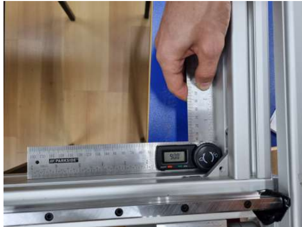
Слика 8.21: Прицврстување на X и Y оска под идеално прав агол со цел да се постигне прецизно движење кај роботската рака.
