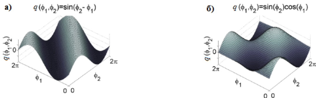
Слика 3.5 – Две карактеристични функции на спрега во фазен домен. а) Функција на спрега користена во моделот на Курамото [3]. б) Функција на спрега користена во моделот на Винфри [1, 74].
